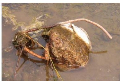
鉄筋付きのコンクリートは回収困難
