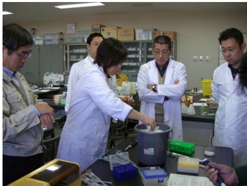
図2 ヒートショックによるプラスミドベクターの導入
