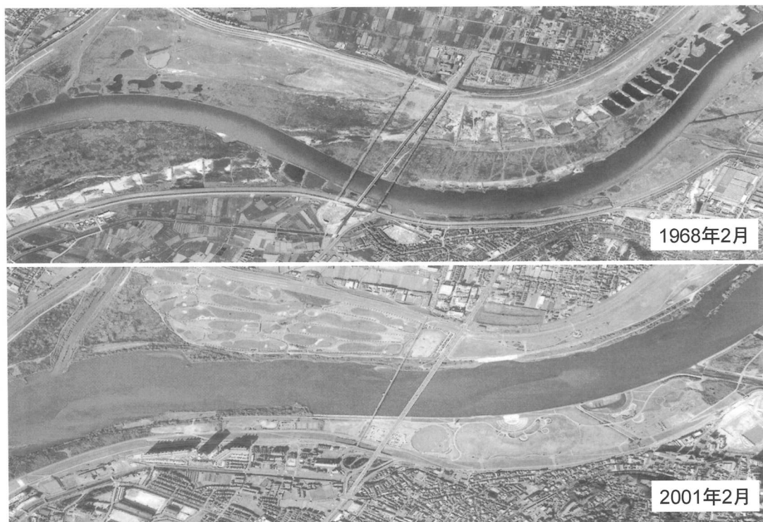
図5. 淀川河道の変遷，枚方大橋付近（国土交通省淀川河川事務所）。
